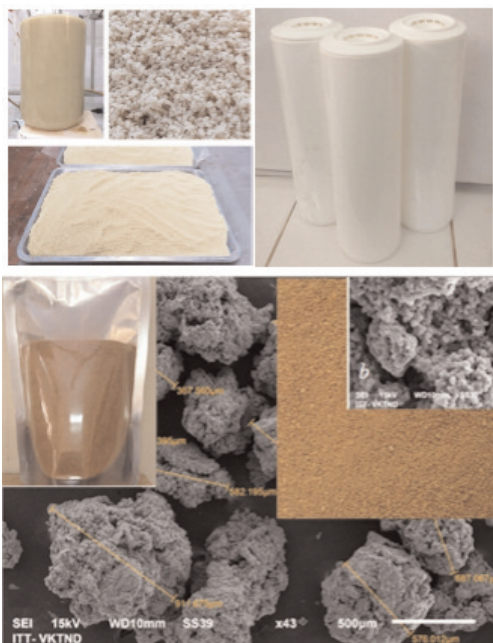
Hình 2: Vật liệu hấp phụ amoni (CAB/CGA): (a) trước khi sấy (b) sau khi sấy và lõi lọc amoni (c)
